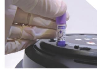
Sterilizasyon işlemi bittikten sonra Bİ'yi bir yuvaya yerleştirin ve sonucu bekleyin. Pozitif kontrol olarak kullanılan Bİ'ün sterilize edilmemesi gerekir.
