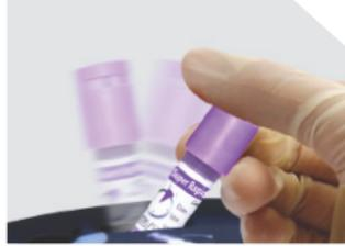
İndikatörü İnkübatör üzerindeki kırıcı ile kırın.
