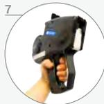
Presione y suelte el gatillo varias veces hasta lograr tensionar el liner.
