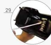
Limpie con ayuda de un hisopo y disolvente las superficies y rodamientos en los que se observe resto de adhesivo /
