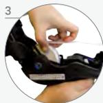
Coloque el rollo de etiquetas entre los sujetadores /
