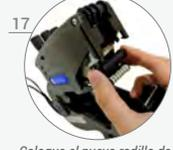
Coloque el nuevo rodillo de tintas presionando fuertemente hasta que quede asegurado en el dispositivo de fijación /
