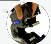
Presione el dispositivo de fijación del rodillo de tinta hasta que el rodillo de tinta se suelte de la fijación y pueda ser removido /
