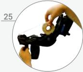
Saque el rollo de etiquetas de entre los sujetadores desplazando el rollo hacia arriba /
