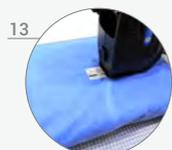
Deslice la etiquetadora hasta que toda la etiqueta quede pegada en la carga /
