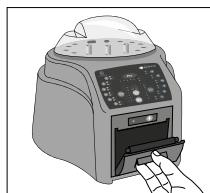
2. Abra la tapa de la impresora y retire el rollo usado.
